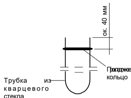
кварцевой трубки (5), прибл. на 40 мм от края (см. рисунок).
