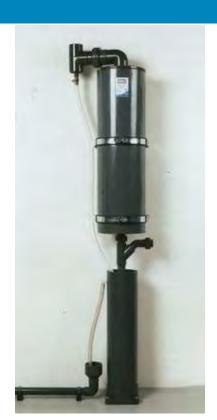
**Устройство удаления остаточного озона СК** предназначен для химико-каталитического преобразования остаточного озона, содержащегося во влажном воздухе, выходящем из резервуаров для смеси озона и воды и из фильтров. Максимальная концентрация озона составляет около 4 г озона на 1 м<sup>3</sup> воздуха.
