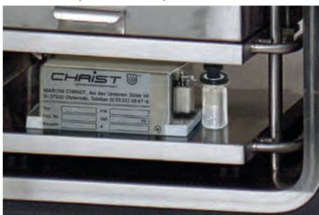
Система CWS-40 для взвешивания в режиме on-line в течение процесса лиофилизации
