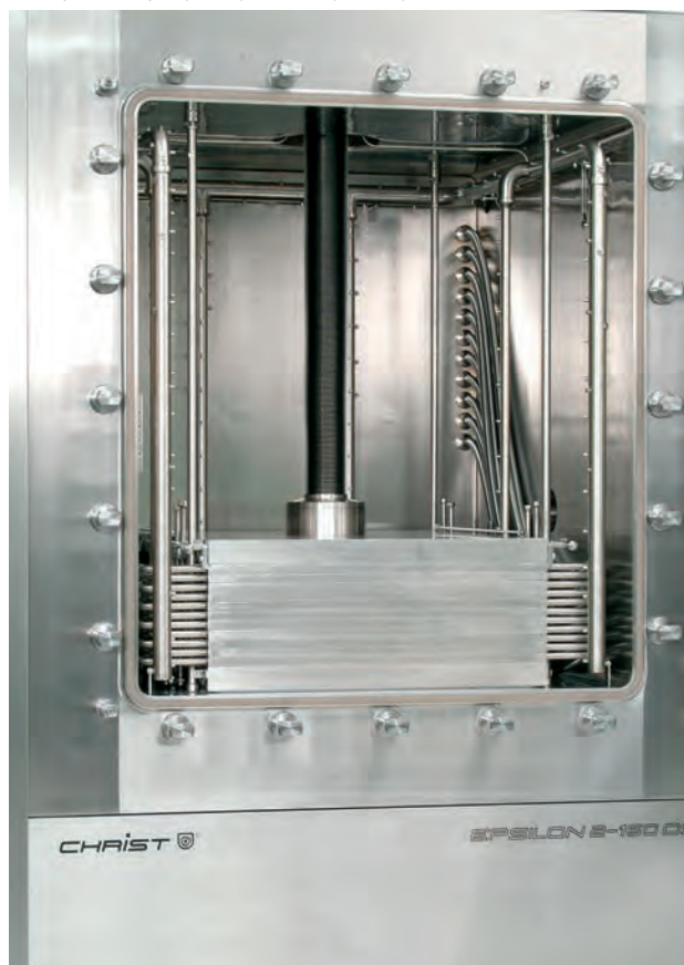
Камера для продукта (полки опущены)
